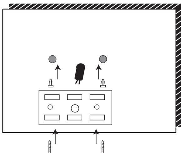
A l'aide d'un tournevis, retirer la plaque du fond qui est clipsée sur le corps de l'applique à l'aide de ressort.
