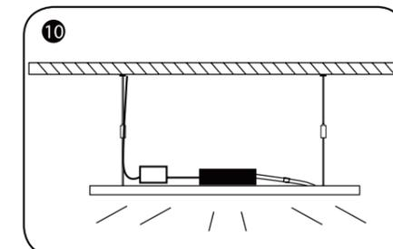
Dans ce type d'installation, pour des câbles d'alimentation, il est requis l'usage d'une double isolation, comme ceux H03VV-F 2 X 0.75mm<sup>2</sup>.
