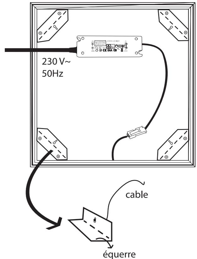
Avant d'incérer le panneau LED dans le faux plafond, vous devez assurer celui-ci. Replier l'une des équerres et au moyen d'un câble (non fourni), assurer le panneau au plafond.
