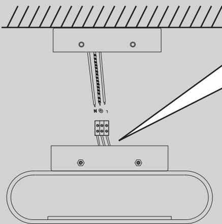
Ouvrir le boîtier de raccordement
