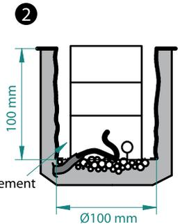
Passez le câble d'alimentation à l'intérieur du pot d'encastrement.
