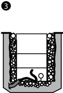
Scellez le pot d'encastrement. Prévoir un joint de dillatation dans ciment ou béton.
