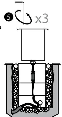
Encastrer le spot dans le pot d'encastrement avec force
