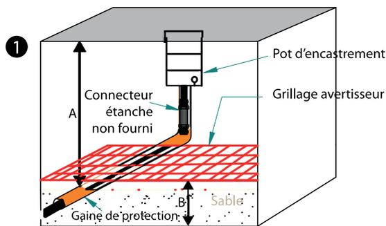
A chaque implantation de l'encastré, creusez un trou avec drainage au fond.
