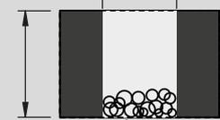
Dans le cas d'une installation encastrée dans le sol à l'extérieur, prévoir un drainage.
