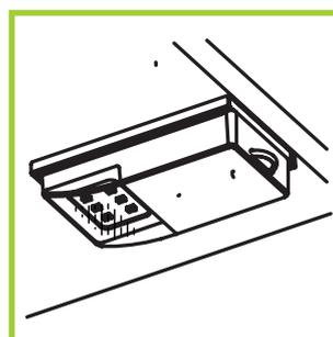
La molette noire joue le rôle d'interrupteur ON/OFF à l'ouverture et fermeture du meuble
