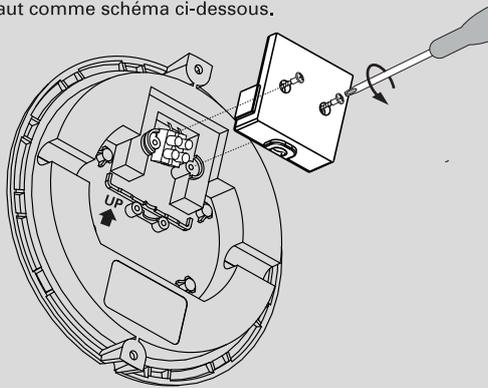
Ouvrir le couvercle à l'arrière du hublot pour accéder au boîtier de raccordement
