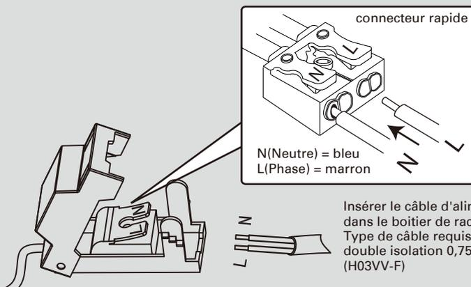
Insérer le câble d'alimentation 230V~50Hz dans le boîtier de raccordement
